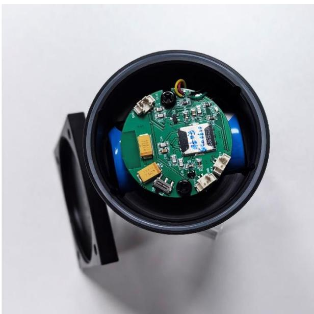
2、PCBA 板中找到产品开关，用镊子或小型一定螺丝刀，把开关拨到“NO”位置，
