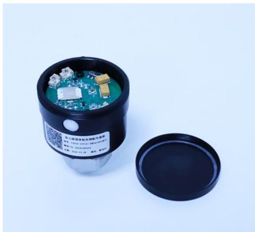
2、PCBA 板中找到产品开关，用镊子或小型一定螺丝刀，把开关拨到“NO”位置，
